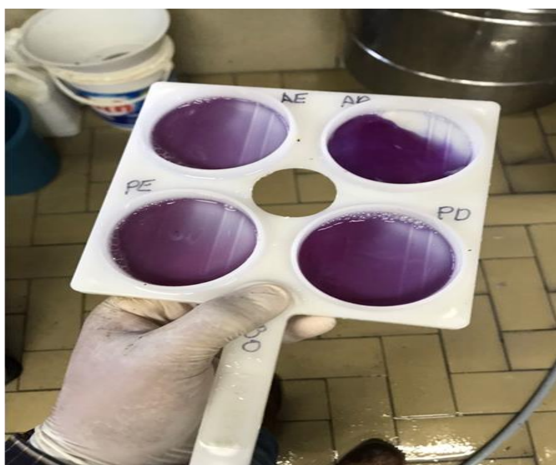
Figura 1 – Raquete devidamente preenchida com leite e reagente.
