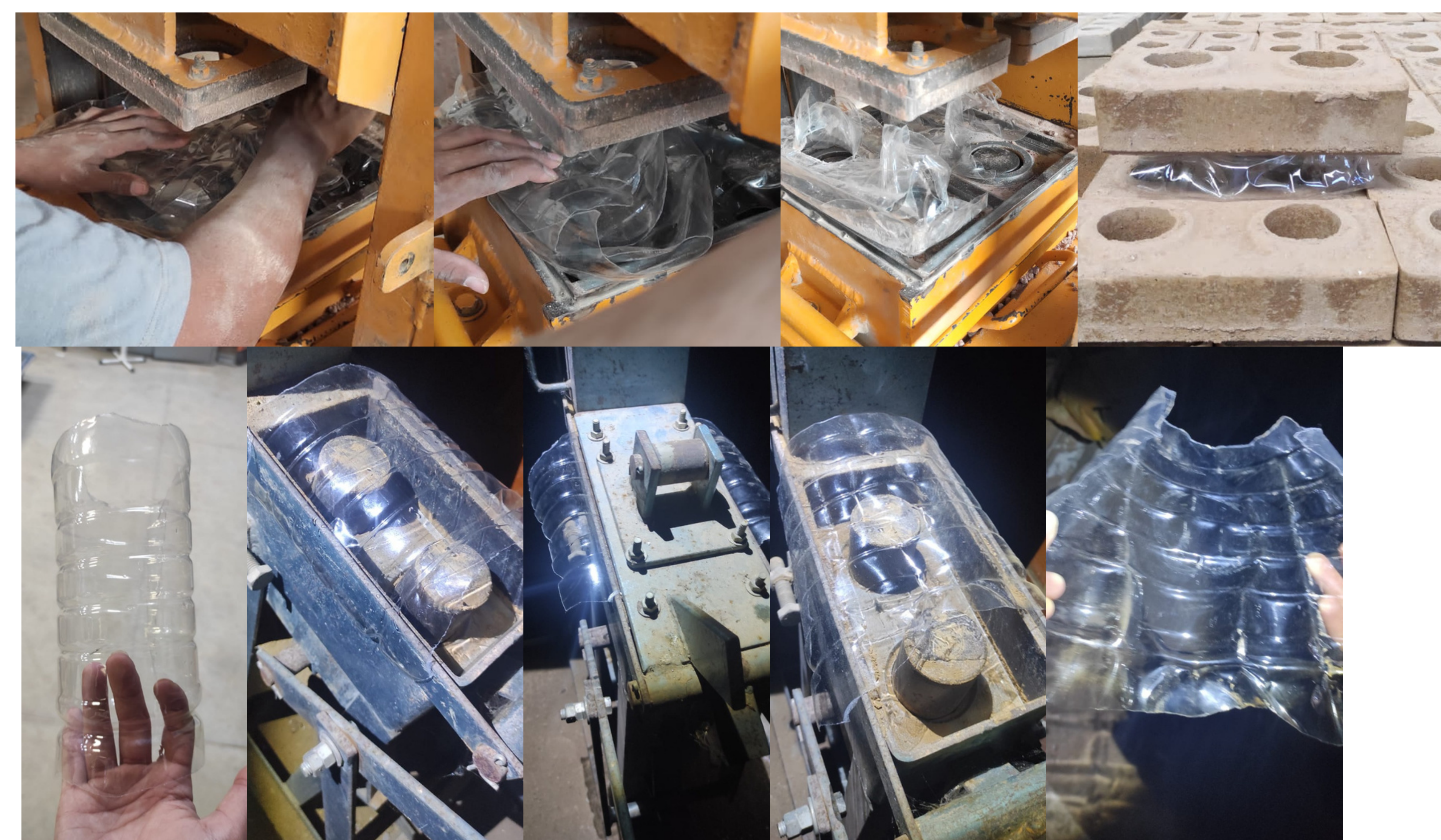
Imagem 03: Nas imagens superiores, são os testes realizados na prensa hidráulica na Fábrica de Viana e as imagens inferiores, são os testes realizados no UNESC com a prensa manual.
