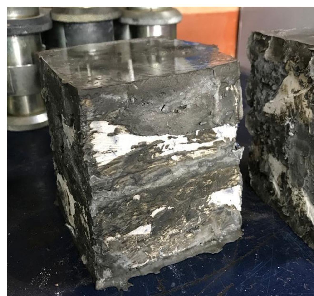
Figura 03: Tijolo de sobra de tecidos pós capeamento. Fonte: Autoras, 2022.
