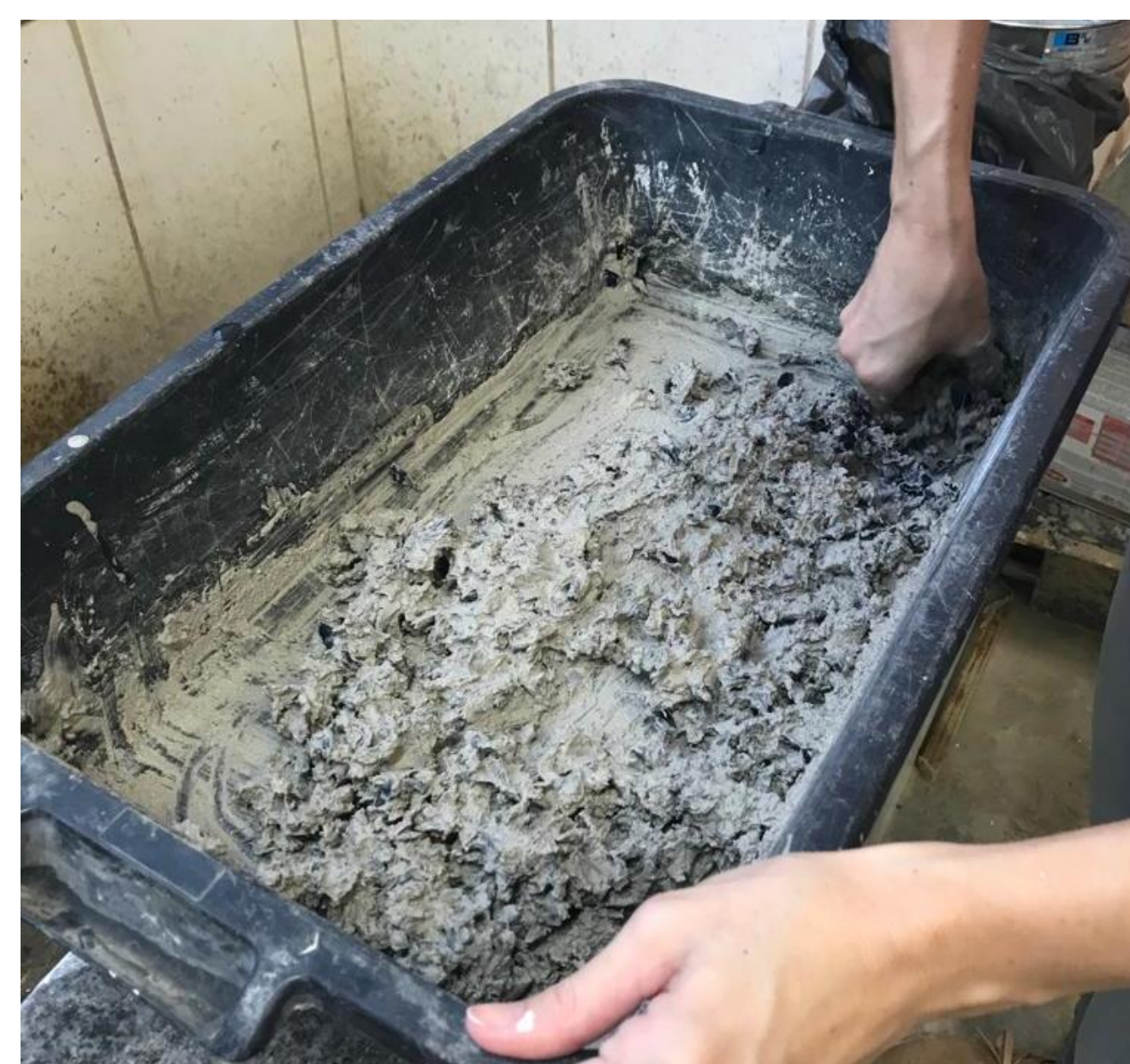
Figura 01: Mistura para confecção do tijolo. Fonte: Autoras, 2022.
