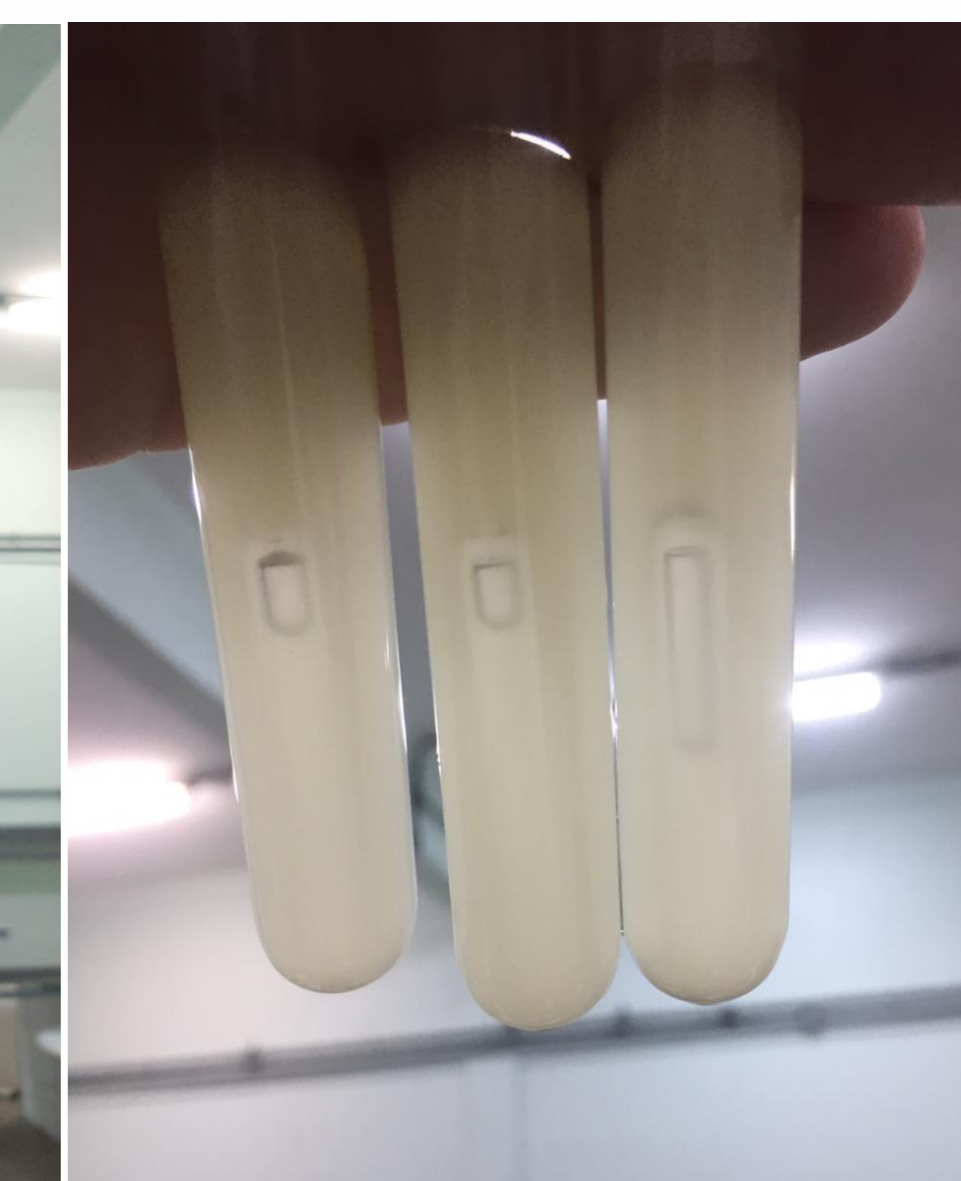
Figura 3 – Tubos de Caldo EC apresentando formação de gás, sendo interpretado como positivo para coliformes termotolerantes
